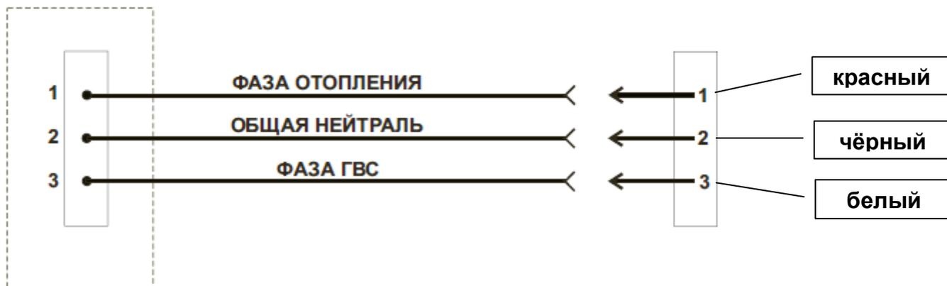
Электрическая схема подключения мотора 3-х ходового клапана, для котлов с композитной гидрогруппой.
