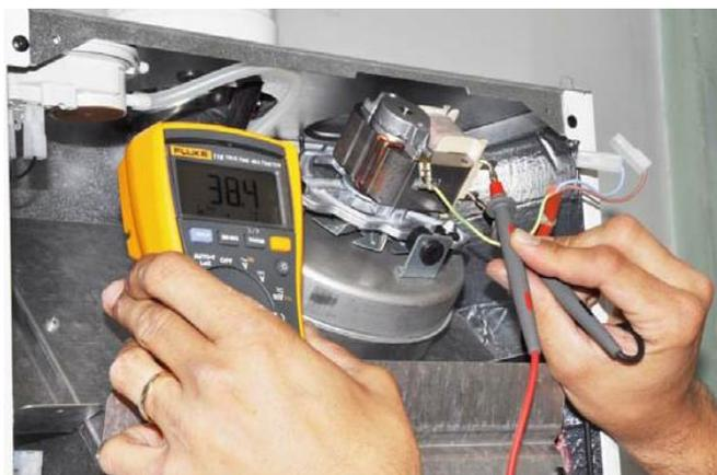
**Для котлов Main5, ECO Compact** сопротивление на зажимах вентилятора 80 Ом(при 20°С).
