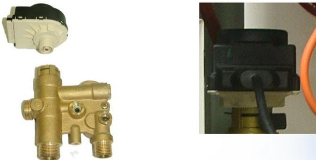
**ТРЕХХОДОВОЙ КЛАПАН** – устройство для переключения потока теплоносителя из первичного теплообменника в систему отопления или во вторичный теплообменник. Выполнен из латуни. Является дискретным механизмом. То есть при нагреве воды контура ГВС контур отопления отключается и наоборот.
